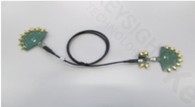
图 1：Type-C CLB board, 1m cable, Type-C to Type-C board, and Mock host/Device, Rx 接收机校准连接图。
