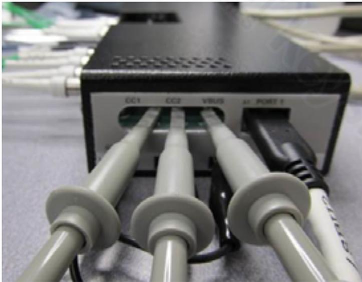
图 7 : 您可以使用是德科技无源探头轻易地探测 N7016A 的 CC1、CC2 和 Vbus 信号。
