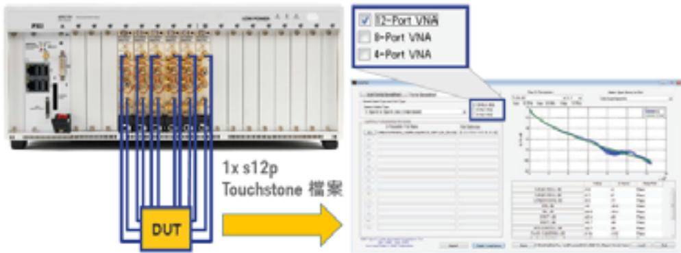
从画面中可以得知，该程序虽然支持 4/8/12 Port 的网络分析仪，但当使用 4-port 网络分析仪时，必须重复接续十来次以取得足够的 S 参数，方能输入 InterPar 作计算。这对于测量来说，不但速度缓慢，而且增加许多人为操作失误的可能性。所以最佳的测试方式还是选用 12-port 的网络分析仪。目前 Keysight 拥有模块化网络分析仪（例如 M937xA 系列），可从 2-port 到 32-port 自由搭配，可在一次完整连接下存储 S32P 参数，是测试 Type-C cable 的最佳选择。
