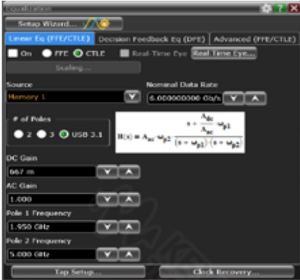
图 9：在示波器中可以支持 CTLE/DFE 的模型。
