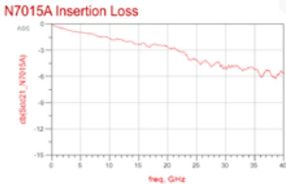
图 10：N7015A 的插入损耗的性能。
