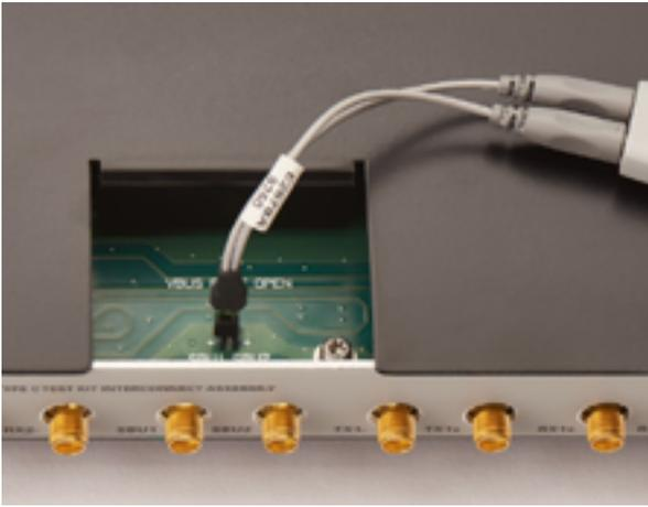
图 8：使用附有 Keysight InfiniiMax I/II 探头放大器的 E2678B 插座接头来探测 D+/D- 信号。
